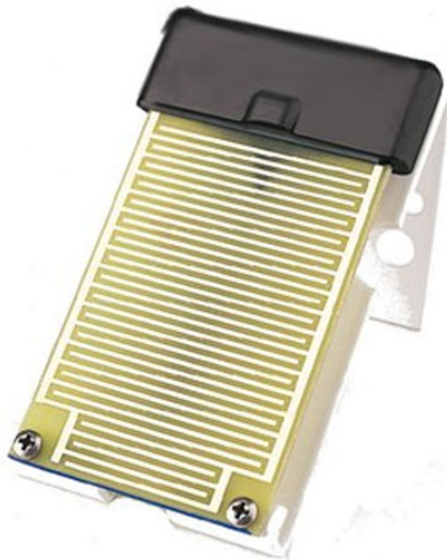
Levélnedvesség érzékelők. (Davis Instruments, Komoline)
