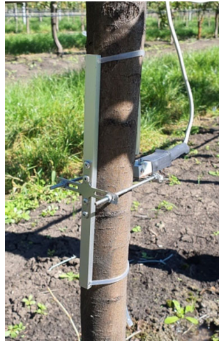
Körtefa törzsére szerelt dendrométer
